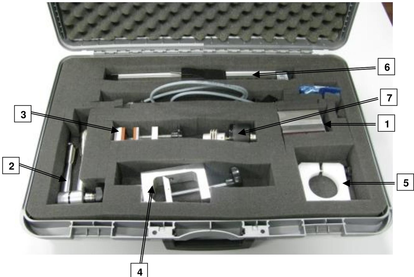
Mostrati nella figura si notano anche il trasduttore lineare (6) con il cavo di connessione, e il trasduttore di rotazione (7) con il suo perno rotante. Si include anche un cavo di connessione di lunghezza 10 metri non mostrato in figura.
