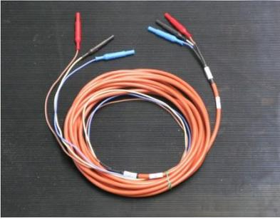
**CAVO #3** NO. 1 Cavo per la connessione alle Bobine dell'Interruttore; il cavo (4G1,5) è lungo 10 metri e terminato su entrambi i capi con connettori di sicurezza a banana da 4 mm. Il cavo è marcato con l'etichetta "3".
