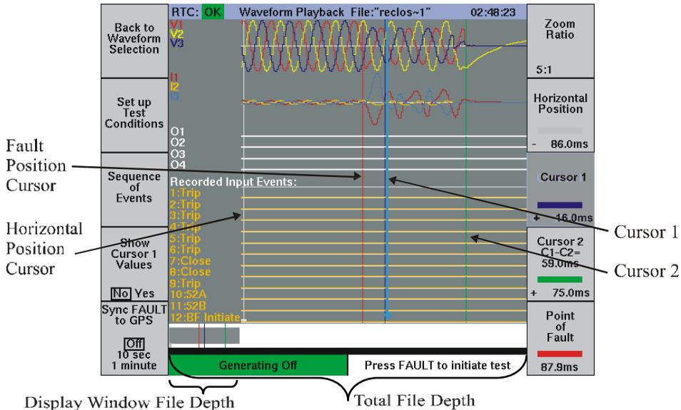
**Figure 7.3 WAVEFORM PLAYBACK FILE DISPLAY**
