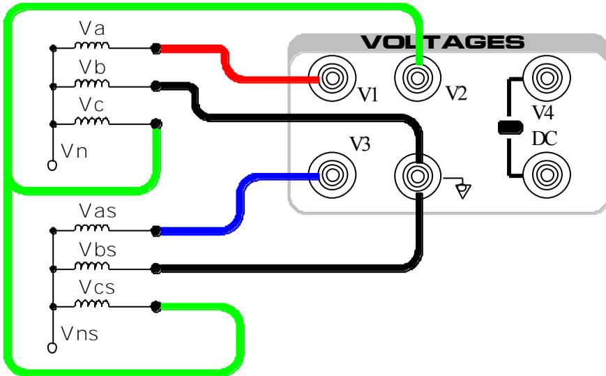
**Synchrocheck Relay: Wiring Type = Delta-Y**
