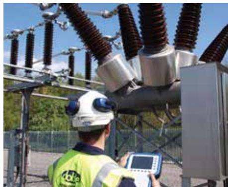
Surveillance de décharges partielles en service avec l'instrument Doble PDS100..
