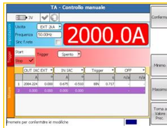
Figura 13 – Prova eseguita su un test di Massima corrente
