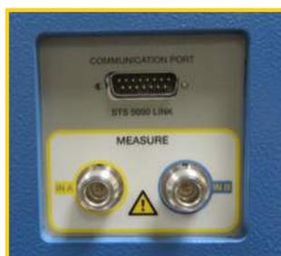
Image 35 – Entrées de mesure IN-A (UST-A) et IN-B (UST-B) sur le panneau latéral
