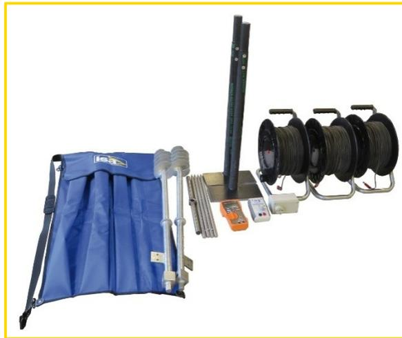
Image 29–Kit accessoires pour essais sur grille de mise à la terre
