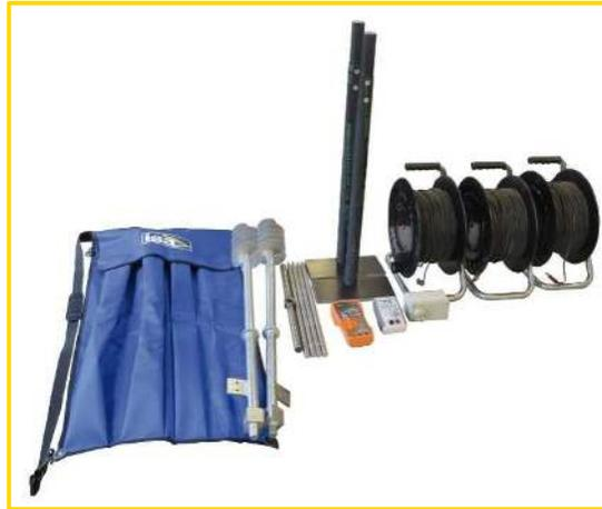
Figura 29 – Kit accessori per prova griglia di terra
