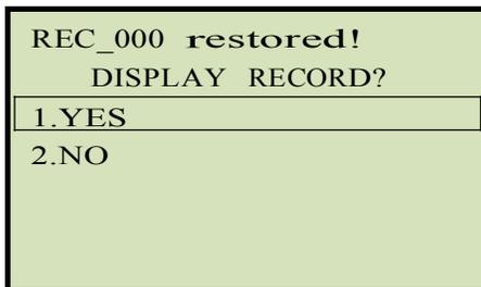
Pritisnite **[1]** taster (*YES*) za prikaz pozvanog test snimka.
