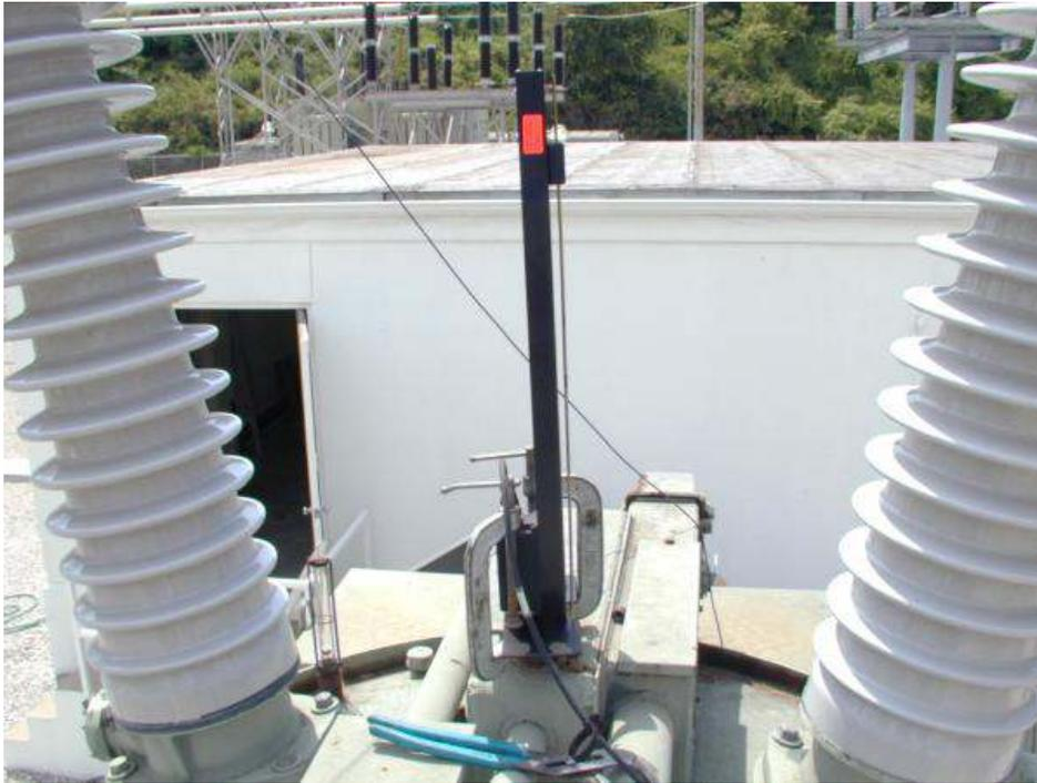
Transductor Lineal montado en un OCB
