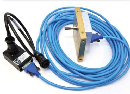
Conectado a un transductor rotacional Doble
