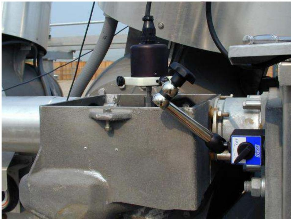
Transductor Rotacional en un interruptor Alstom HE 1014
