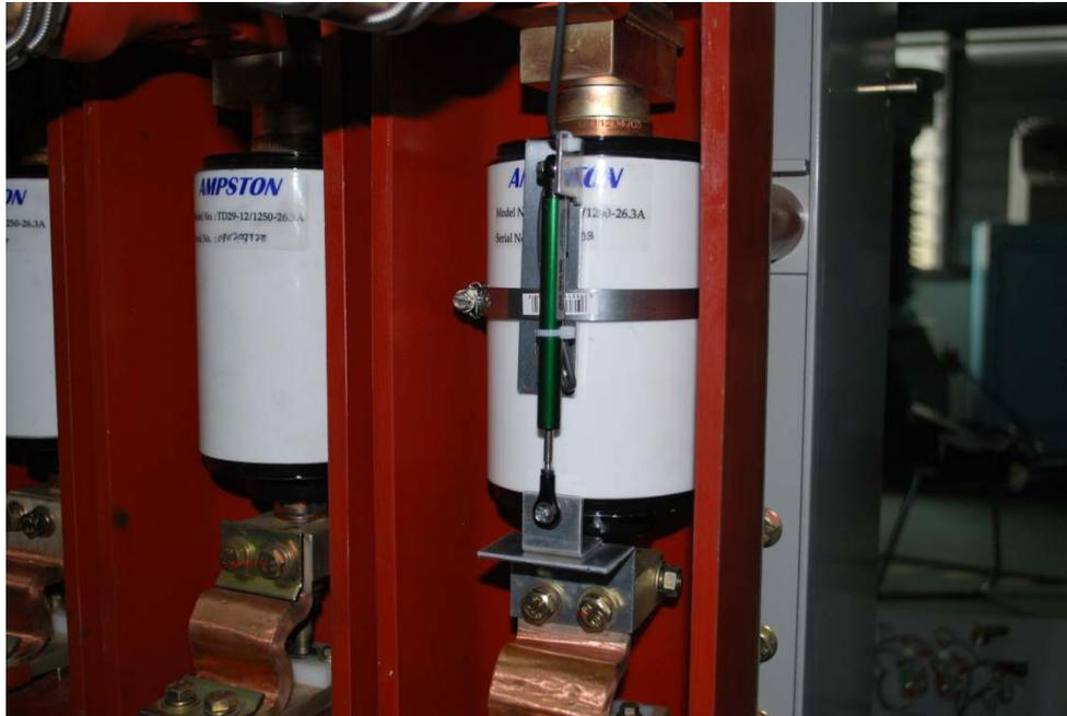
Transductor Resistivo en Interruptor en Vacío
