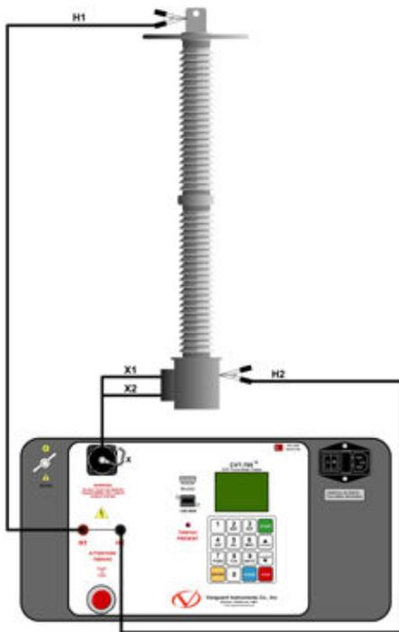
Vanguard的CVT-765是一款基于微处理器的单相全自动变压器绕组变比测试仪。这款便携式测试仪器专门设计用来测试容性电压互感器（CVT）的绕组变比。
