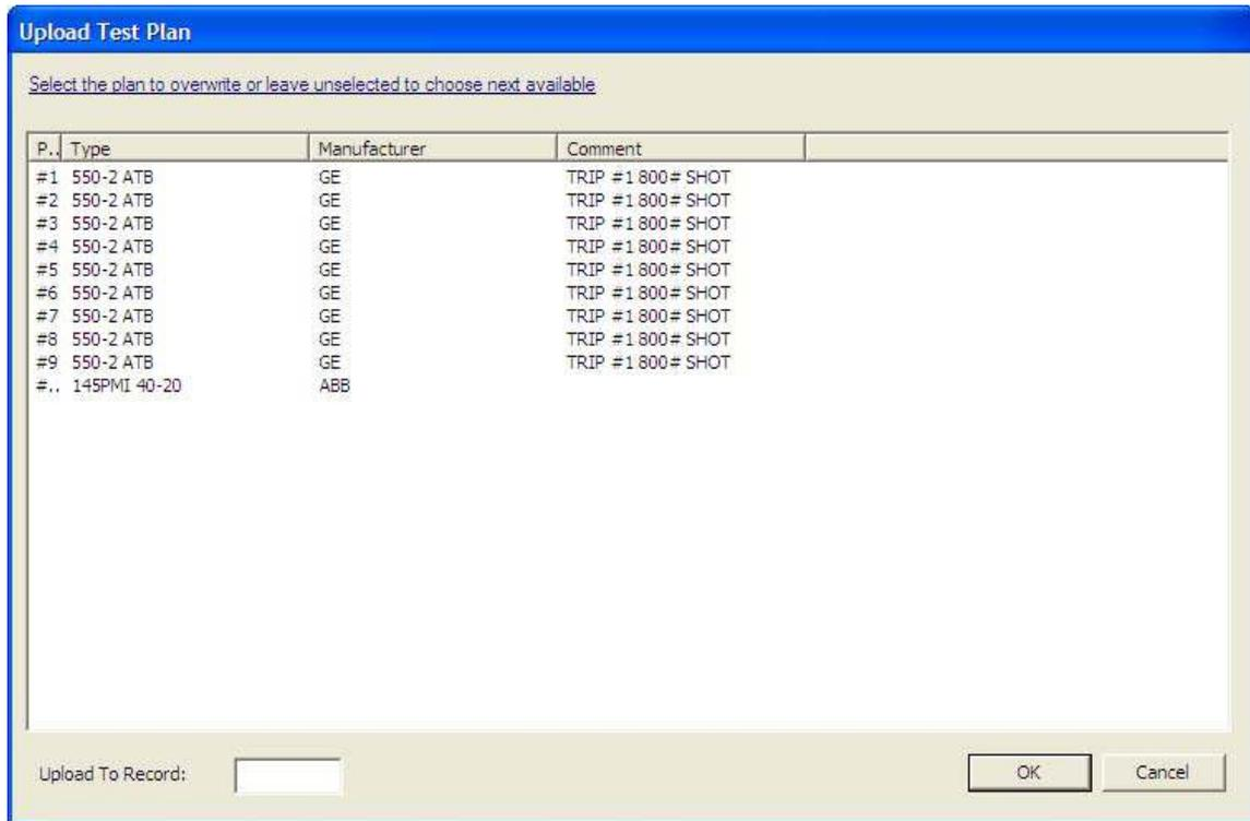
Desde esta ventana usted puede elegir sobrescribir el plan de ensayos existente almacenado en el analizador CB. Esto puede ser útil si ha sido usada toda la memoria interna y no hay lugar para almacenar un plan adicional.
