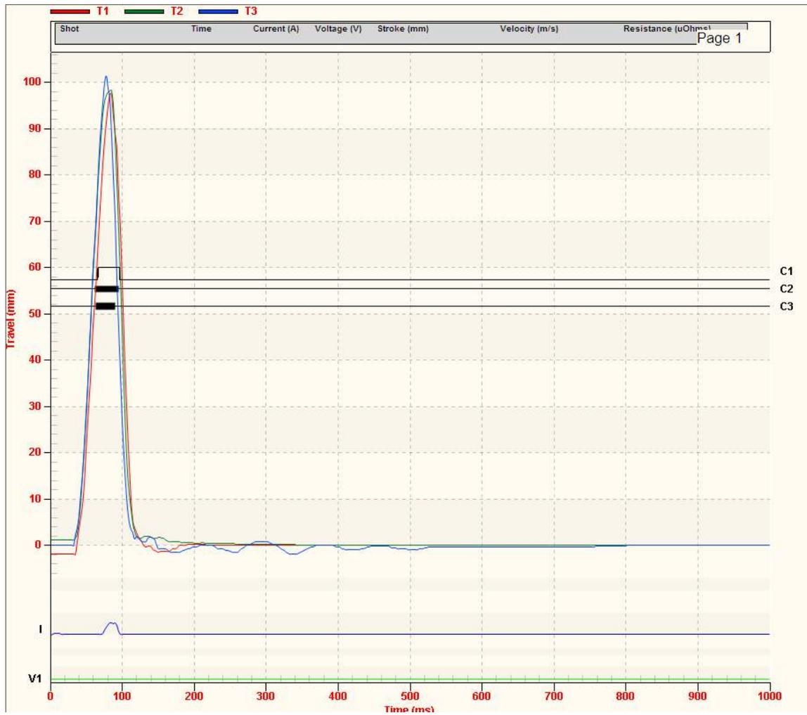
Figura 2. Gráfico de Canales de Contactos en Formato Analógico (C1) y Digital (C2 y C3)
